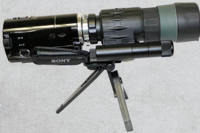
Модуль прибора включает в себя монокуляр, содержащий усилитель яркости изображения (электронно-оптический преобразователь – ЭОП) с входным объективом и окуляром, и встроенный инфракрасный (ИК) осветитель.
