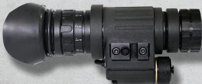
Конструктивно прибор выполнен в виде монокуляра, содержащего усилитель яркости изображения (электронно-оптический преобразователь – ЭОП) с черно-белым свечением экрана, объектив, окуляр и встроенный инфракрасный (ИК) осветитель.
