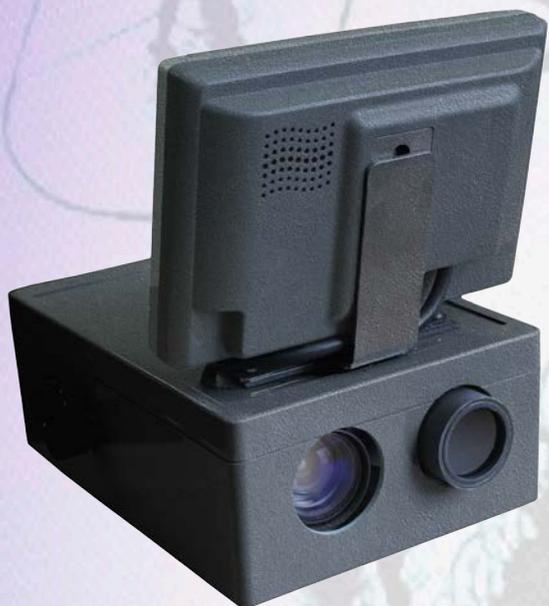
Данный прибор является перспективной разработкой. Предназначен для дистанционного контроля высоковольтного энергетического оборудования находящегося под напряжением. В основе метода диагностики лежит определение характеристик коронных (КР) и поверхностно-частичных разрядов (ПЧР), а так же их зависимостей от величины напряжения и степени загрязнения изоляции.
